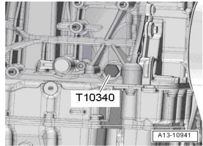
Провернуть коленвал до упора в направлении вращения двигателя.
