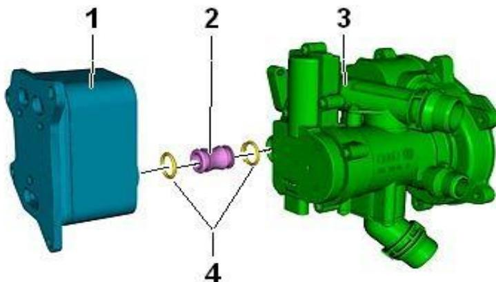
Установить исполнительный элемент терmostата -N493--3- на соединительный патрубок и надвинуть на посадочные штифты.
