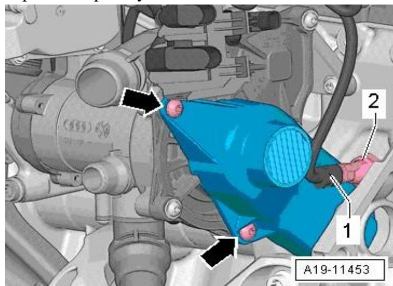
Удерживая шкив зубчатого ремня -1- насоса системы охлаждения на шкиве поликлинового ремня, выкрутить винт с помощью динамометрического ключа - V.A.G 1331- с торцевой насадкой -T10360-.
