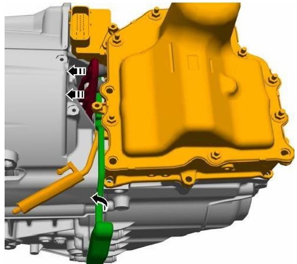
Монтировку -T10407- повернуть в -направлении стрелки- влево и снять рычаг включения с толкателя.
