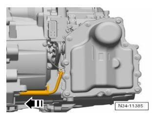
должен иметь повреждений. Датчик частоты вращения входного вала КП -G182своим язычком должен полностью и плотно прилегать к картеру коробки передач.
