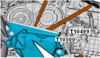
Проверить положение "ВМТ" распредвала и коленвала:
