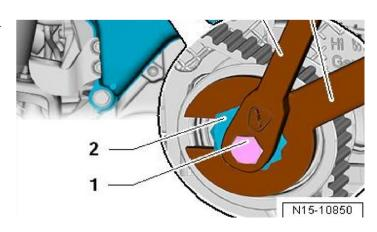
Стопорный болт -Т10340- вкручен в блок цилиндров до упора и затянут моментом 30 Нм
