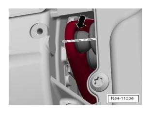
Обратить внимание на то, чтобы толкатель точно вошёл в зацепление с подшипником рычага включения. Вытянуть толкатель рукой, чтобы от вошёл в подшипник.
