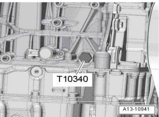
Повторно определить верное положение коленвала для ввинчивания стопорного болта.
