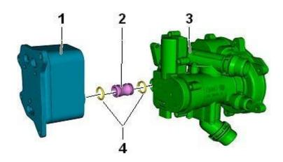
Установить исполнительный элемент термостата -N493--3- на соединительный патрубок и надвинуть на посадочные штифты.
