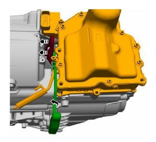
Монтировку -Т10407- повернуть в -направлении стрелки- влево и снять рычаг включения с толкателя.
