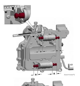
При обращении и установке обратить внимание на то, чтобы вилка переключения передач случайно не выдавилась из своего положения. Также следить за рычагом включения и толкателем мехатроника. Ввернуть винты -A- (3 шт., M8 x 35) и -B- (2 шт., M8 x 90) рукой в перекрёстном порядке. Снять направляющий палец -T10406-. Ввернуть остальные винты -B- (2 шт., M8 x 90) от руки.
