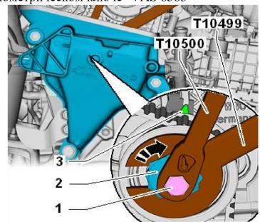
Установить на динамометрическом ключе -V.A.G 1410- меньший момент затяжки 12 Hm!
